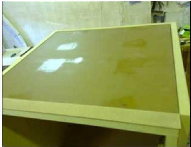
Figuras 2.1 - 2.2. Lámina densa colocada en la cámara emisora entre la doble pared.
