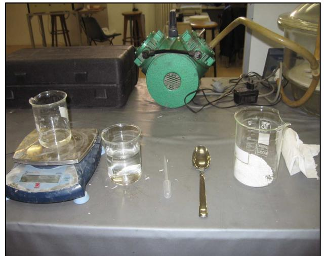
Figura 3.13. Instrumentos necesarios para realizar las probetas
