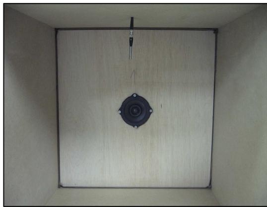
Figura 2.23. Aislamiento con lámina densa.
