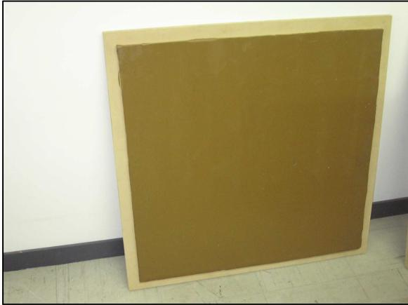
Figura 2.24. Panel ciego aislado con lámina densa
