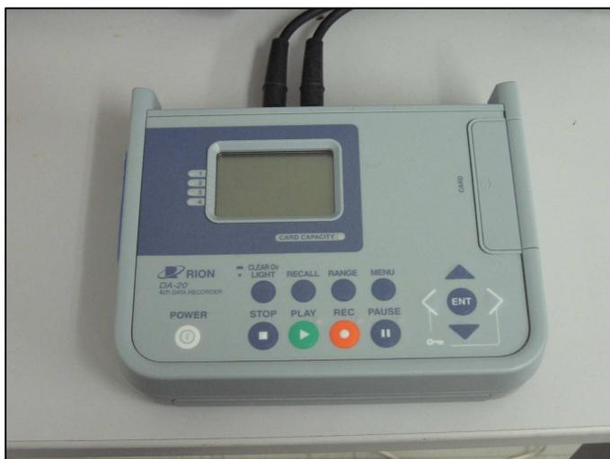
Figura 2.11. Sistema de adquisición de datos RION
