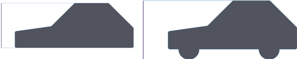
Figura 78. Àrees frontals (línia lila) per una forma bàsica menystenint les rodes i l'altre tenint-les en compte.
