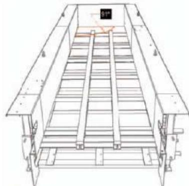
7.2.2 Cajón: construido en chapa de acero. Su forma divergente hacia la salida facilita el desplazamiento del material. Un laberinto ubicado en los laterales inferiores del cajón, previene las pérdidas de material, manteniendo la limpieza de la instalación.
