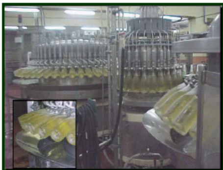
Con la instalación de bandejas de recogida de goteos en las líneas se ha reducido mucho la contaminación de las aguas.
