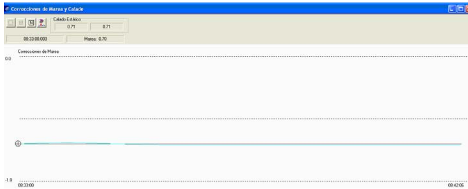
Figura 8-9. Marea. En negro se muestra la marea corregida por el mareógrafo y en cian los datos de marea recibidos del GPS RTK. Se observan oscilaciones en el perfil del GPS ya que éste no está filtrado.
