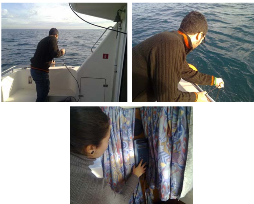
Figura 7-9. A continuación se muestra el procedimiento del lanzamiento el Perfilómetro (sensor de velocidad del sonido del agua).
