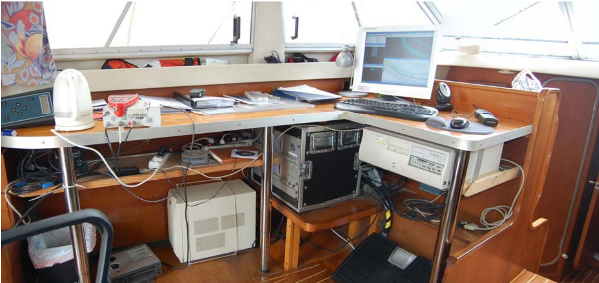
Figura 7-5. Fotografía del soporte informático y de los Equipos Hidrográficos montados a bordo de la embarcación.
