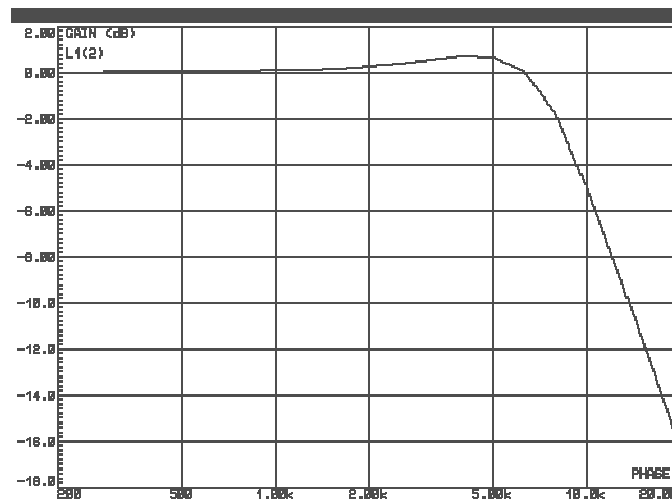
Fig. 2.4 Filtre passa baixos de tercer ordre.
