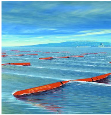
Simulació d'una planta de 40 Pelamis produint 30 MW.
