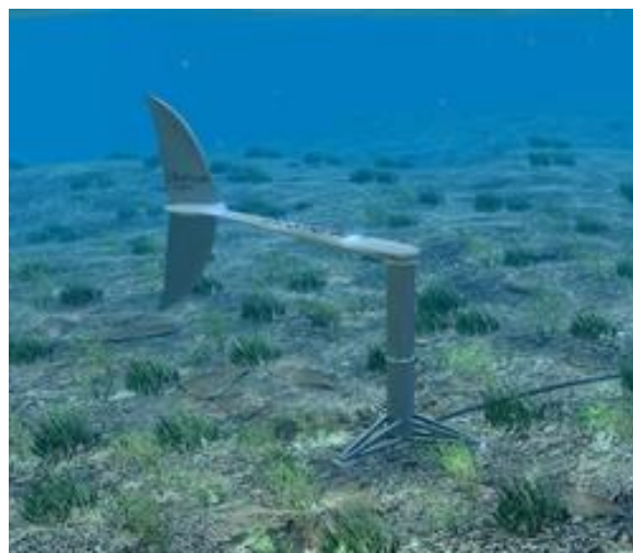
Representació del sistema bioStream™ ancorat al fons marí.
