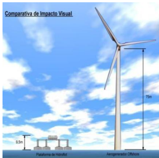
Comparativa de l'impacte visual generat pel dispositiu Calma i un aerogenerador offshore.
