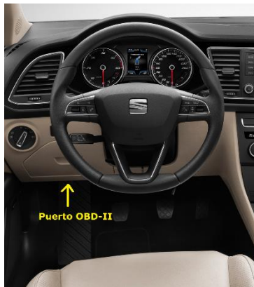
Figura 3. Acceso del puerto OBD-II desde el asiento del conductor.
