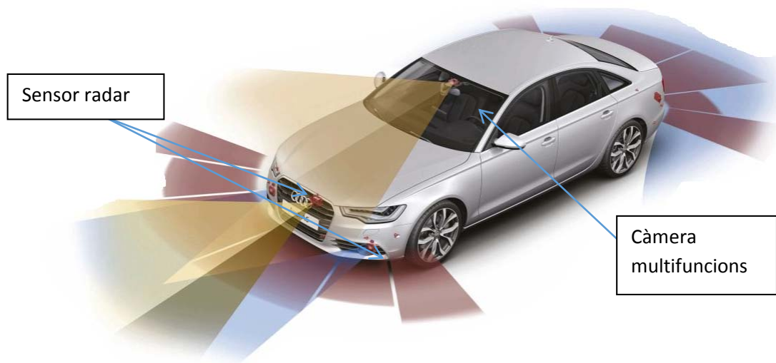
Il·lustració 63. Càmera multifuncional i sensors radar [Font: www.audi.es ]
