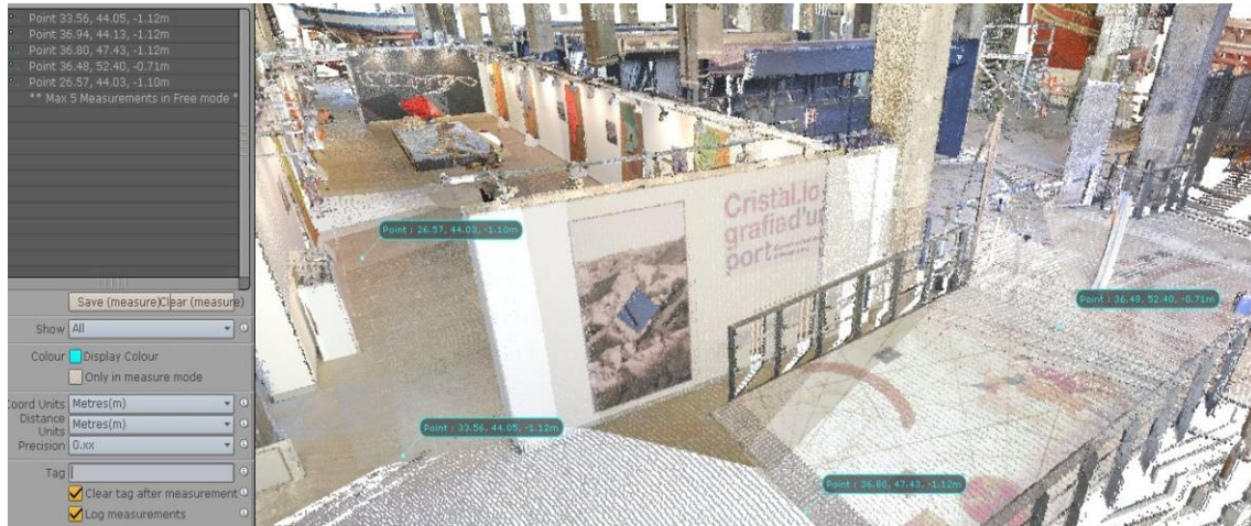
Figura 6. Imagen obtenida a partir de la nube de puntos coloreada del TLS
