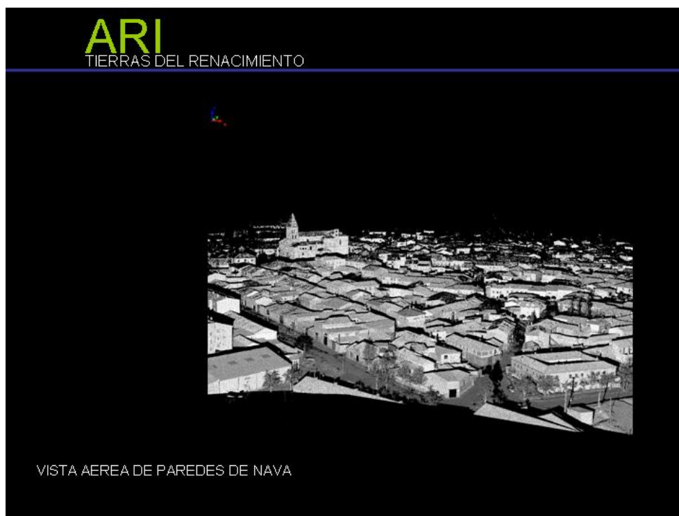
Figura 1: Nube de puntos correspondientes a un escaneo global de Paredes de Nava desde el tejado de un silo próximo
