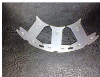
. Figura 11. Dents desmuntables. Es bobinen separatament cada una de les dents i després s'assembla el conjunt. En aquest cas son dents per a muntatge amb rotor interior.
