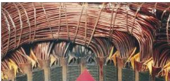
Figura 3. a. Bobinat Distribuït; b. Bobinat concentrat.
