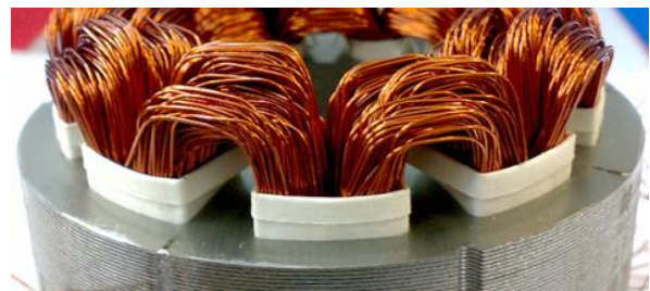
Figura 3. a. Bobinat Distribuït; b. Bobinat concentrat.
