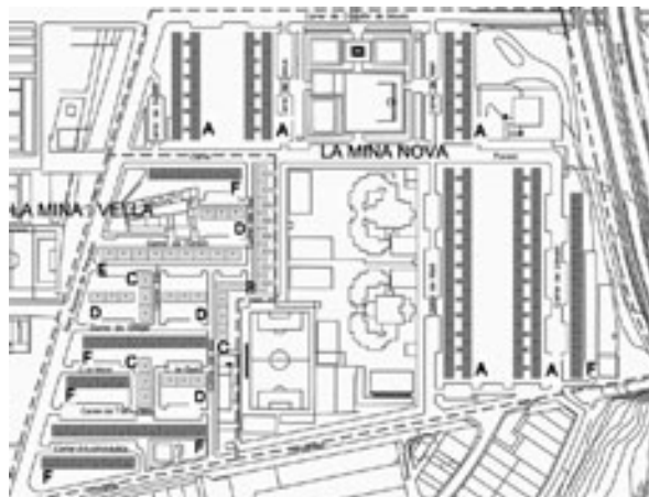
A, F: EDIFICIS CONSTRUÏTS AMB ESTRUCTURA D'ENCOFRAT TÚNEL. B, C, D, E: EDIFICIS CONSTRUÏTS AMB TÈCNiques CONVENCIONALS.
