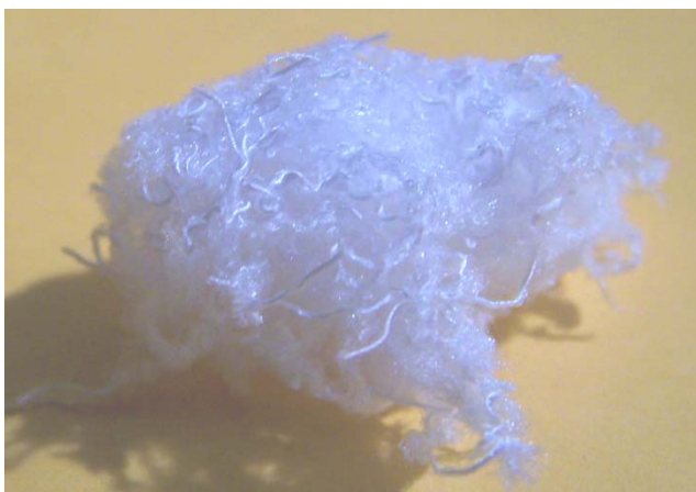
FIGURA 1: Aspecto de la fibra esponjosa a baja concentración de fenol en ausencia de ácido acético.
