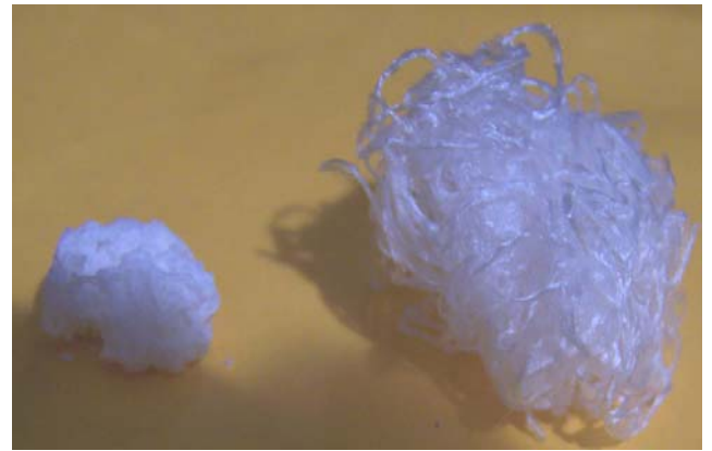
FIGURA 3: Aspecto de la fibra en ausencia (izquierda) y presencia (derecha) de ácido acético.
