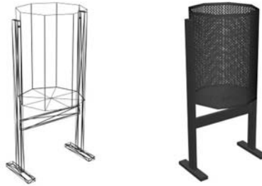
Ilustración 10 Proceso de análisis de una papelera, descomposición en una geometría sencilla
