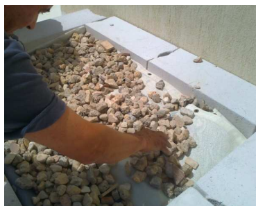
Maqueta secció forjat + Y-Tong + àrid reciclat
