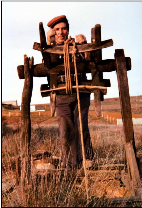
Torno para extraer la tierra durante la construcción de una bodega
