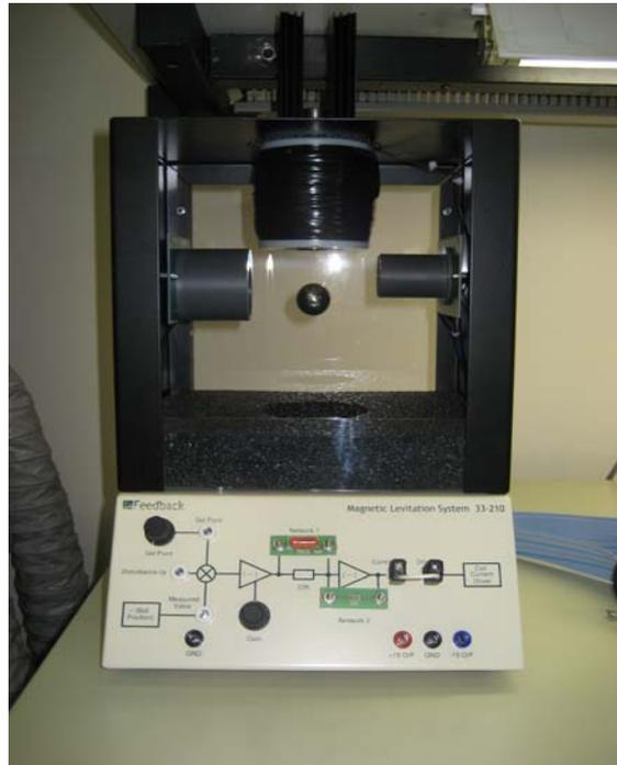
Figura 5. Levitador magnético de Feedback Instruments Ltd.
