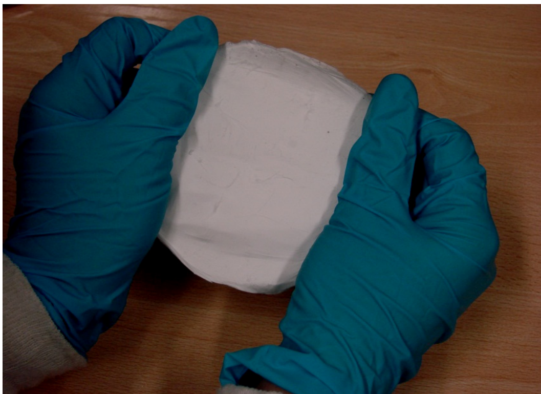
Figura 3. Red de PDLLA realizada por electrohilado.
