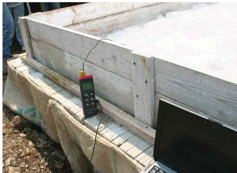
Fig. 10. Detalle de las temperaturas alcanzadas durante el apagado en balsa, se alcanzan hasta 99°C
