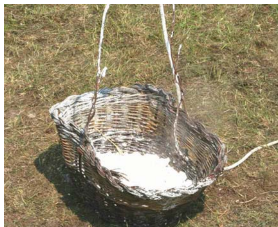
Figuras 5 y 6. Proceso de apagado por inmersión breve
