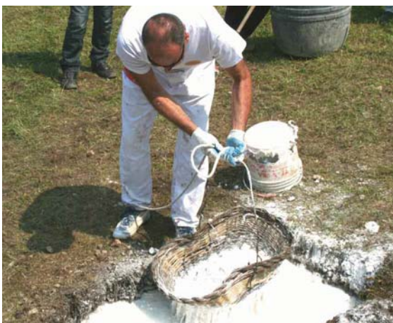
Figuras 5 y 6. Proceso de apagado por inmersión breve
