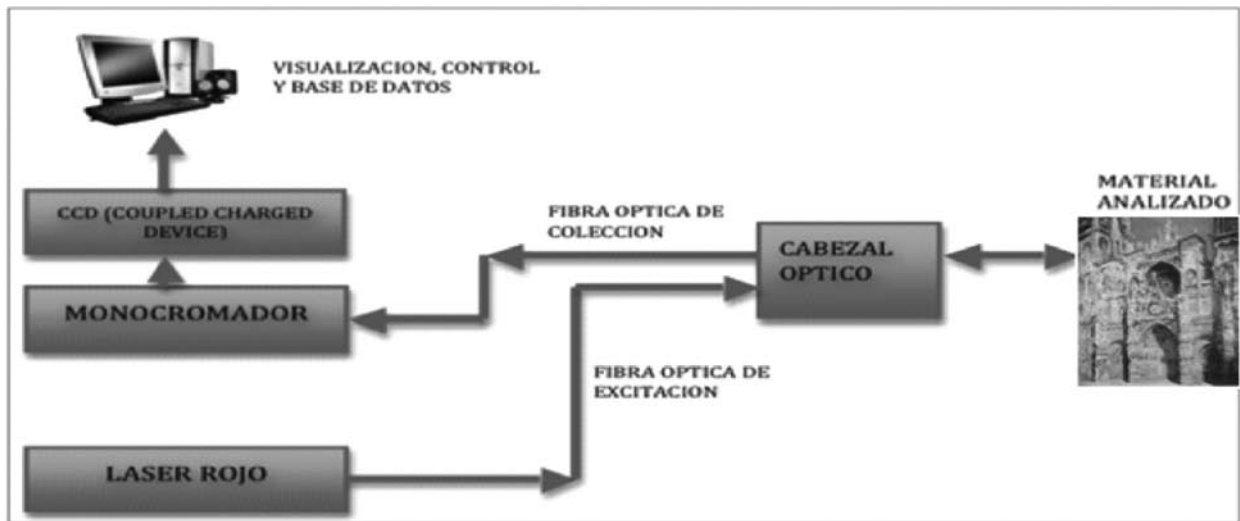
Figura 6. Diagrama de bloques del sistema de espectroscopia Raman con tecnología de fibra óptica
