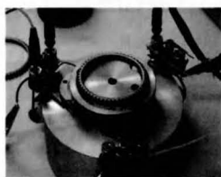
Figura 10. Sistema de excitación y grabación de señales de resonancia por ultrasonidos. Un sensor transmisor y dos sensores receptores se colocan simétricamente alrededor de la pieza metálica sinterizada circular y con simetría axial.
