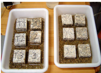
Montaje del ensayo de absorción por capilaridad de probetas de granito amarillo jara .
