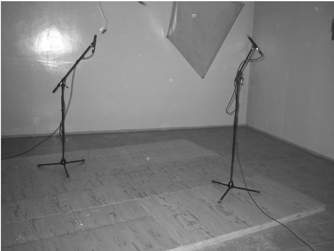
Kuva 2.7. Materiaalien absorptiosuhteet mitataan laboratoriossa, jonka seinät ovat kovia, lähes täysin heijastavia pintoja.
