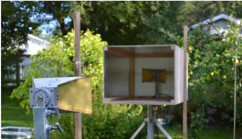
Kuva 4. Mittausjärjestely rakennusmateriaalimittauksissa. Metallivuoratun kopin avulla pyrittiin vaimentamaan mahdollisia monitiekomponentteja vastaanotossa.
