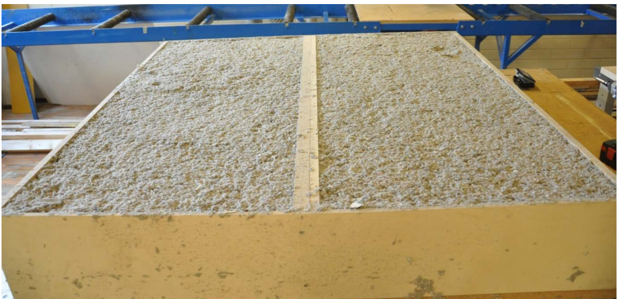
Kuva 7.3.12 Puukuitueristeellä eristetty koerakenne ilman sisäpintalevyä.
