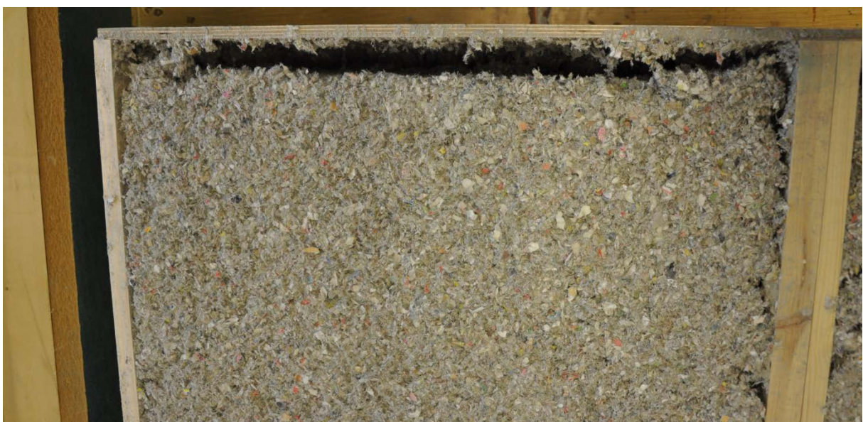
Kuva 7.3.14 Painuman jälkiä koerakenteessa, jossa ilmarakoa ei ollut vielä välittömästi puhalluksen jälkeen (puukuitueriste 320 mm, normaali).
