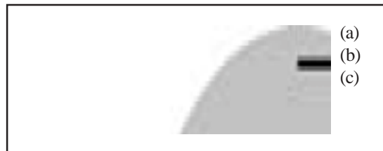
Figura 9. Partícula de HAp parcialmente fundida durante la proyección (a) capa externa deshidroxilada (b) capa intermedia estequiométrica fundida (c) HAp cristalina original
