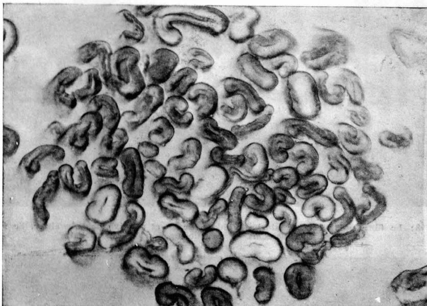
Figura 10a: Se ilustra una sección transversal de algodón tratado con el Arigal C y luego teñido con el Rojo Bencilo sólido B, colorante que tiñe sólo a la resina y reserva al algodón. Se ve que el Arigal C ha penetrado dentro de la fibra, llenando prácticamente toda su sección transversal.
