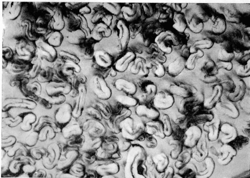
Figura 11: En el caso de una resina en un sistema ácido coloidal, como se emplea en la producción de papel resistente a la humedad, el baño ácido de la resina es primeramente madurado, formándose partículas coloidales cargadas que tienen substantividad. Las partículas de la resina permanecen en el exterior de la fibra, no dando ninguna protección contra los microorganismos. Los aglomerados de resina teñidos de rojo son claramente visibles en el exterior de la fibra.
