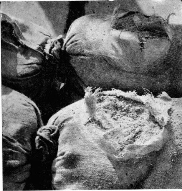
Figura 30: Una toma de cerca de la zona de contacto entre los sacos de yute no tratado. El ataque biológico es fácilmente visible.
