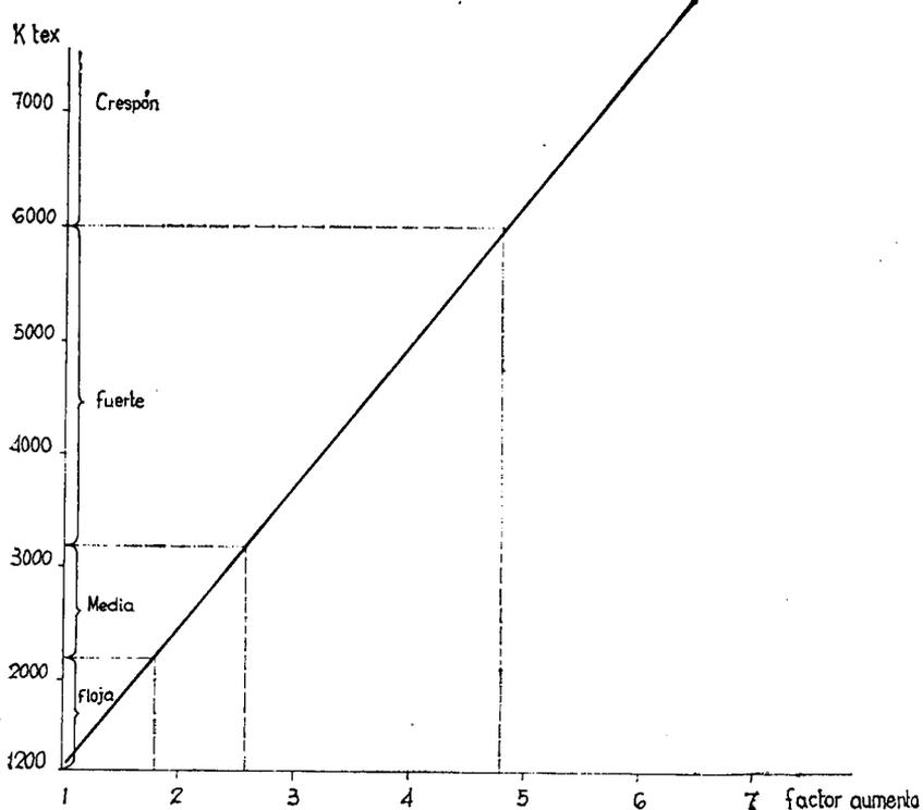
Fig. 14. - Para hilos de lino, lana, viscosa cupro y poliester
