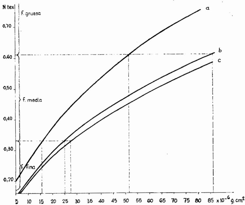
Fig. 7. - Rigidez de las fibras artificiales acetato (a), viscosa (b) y cupro (c)
