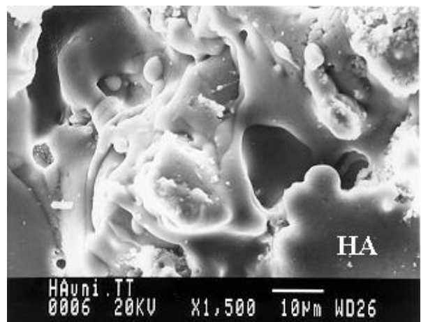
Figura 7. Microestructura de la superficie del revestimiento de HA después del T. Térmico.
