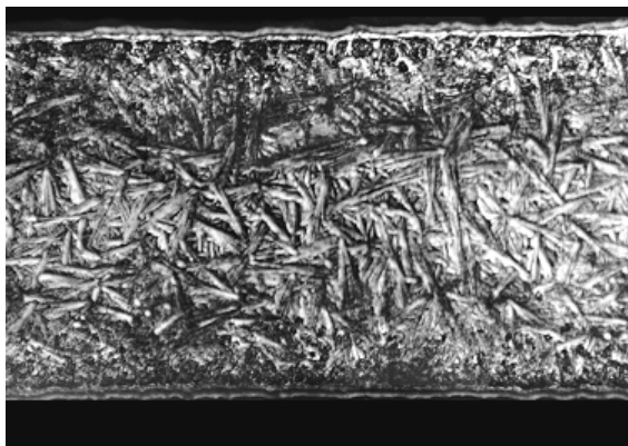
Figura 1. Alambre de ortodoncia tratado a 1000° durante 20 minutos (x500).
