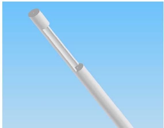
FIGURA 2: Tubo sostenedor de los hilados
