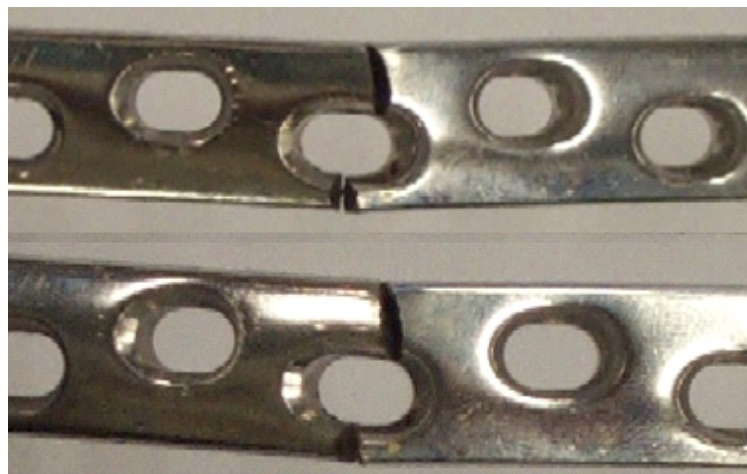
Figura 3. Placas DCP retiradas por fallo prematuro.
