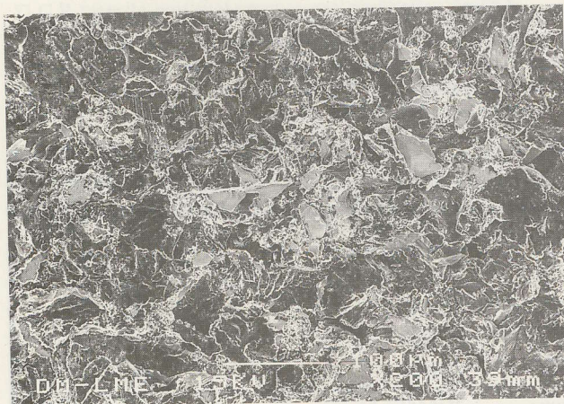
FIG. 8.—Micrografía de la superficie de un disco de titanio tratado con shot peening con partículas de proyección de \text{Al}_2\text{O}_3 .
