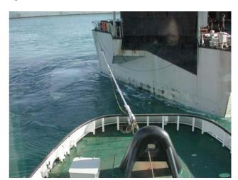
De las mediciones se deduce que los picos de carga son muy elevados, de forma proporcional al tamaño del buque a remolcar. Por consiguiente, durante la vida operativa del calabrote las fibras textiles sufren tensiones de tracción muy elevadas en forma discontinua. Es evidente que a parte del cambio morfológico que representa en el calabrote (rigidez, disminución de sección), también el material sufre un fenómeno de pérdida de
