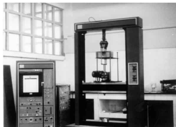
**Figura 2** Vista general de la máquina de ensayos Instron.
