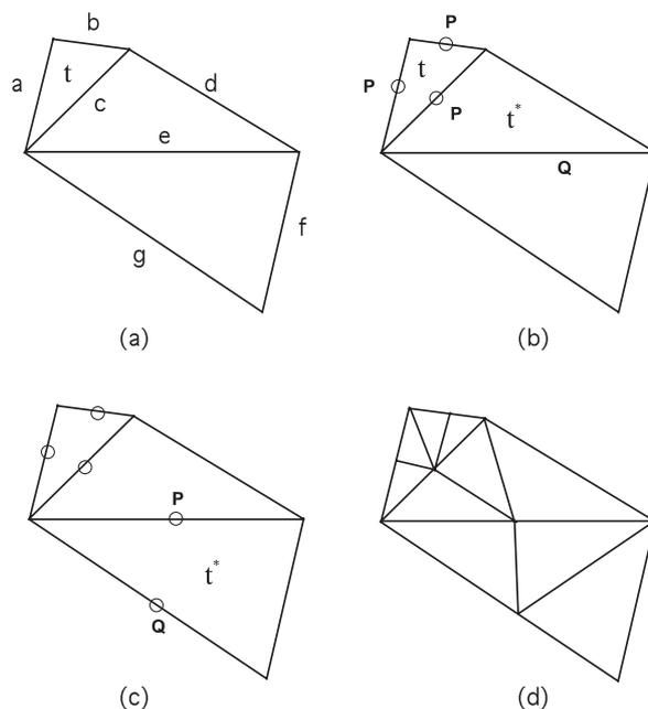
Figura 3. Algoritmo de refinamiento en 2D
