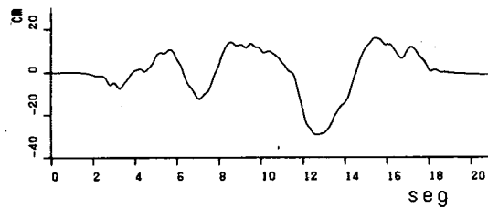
Fig. 9.— Historia temporal de la respuesta en desplazamientos no controlada para el grado de libertad 5.
