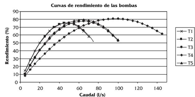
Figura 8. Curvas características caudal rendimiento de la bomba (Q- $\eta$ ) para el conjunto de bombas seleccionadas.
