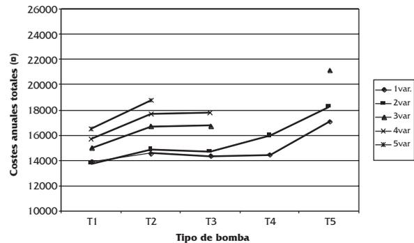
Figura 9. Evolución del coste total anual para los distintos tipos de bombas con la opción de que todas sean iguales y se permita distinto número máximo de variadores de velocidad.
