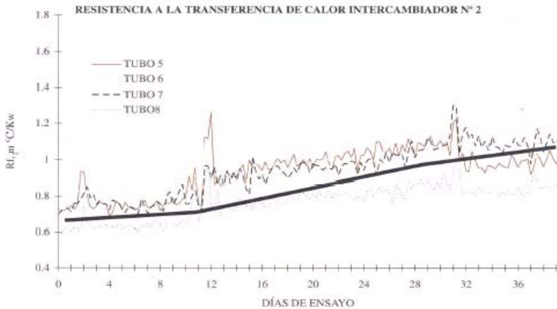
Figura 9. Resistencia a la transferencia de calor para los tubos del intercambiador N° 2, para los 39 días de ensayo.
