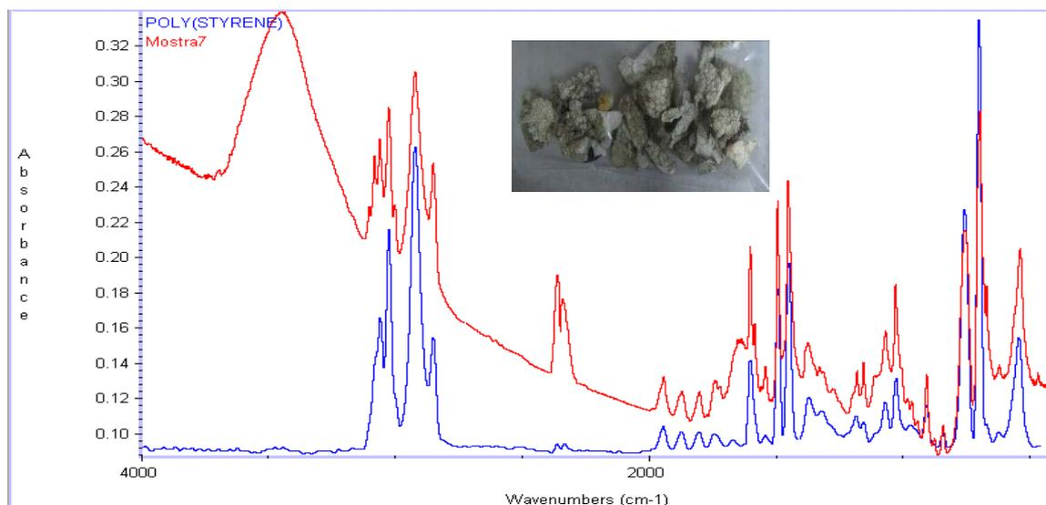
**Figura 4:** Resultado de FTIR para muestra identificada como PS por la t cnica flotaci n.
