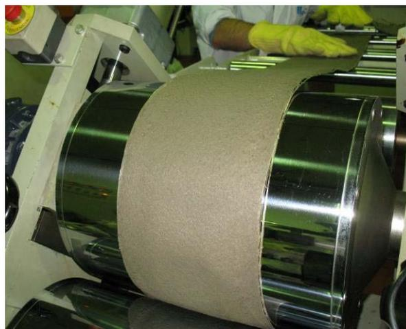
**Figura 5:** Proceso de extrusi n-calandra del residuo mixto
