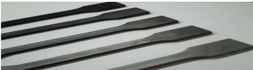
**Figura 6:** Probetas moldeadas por inyecci n
