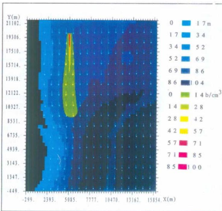
Figura 11. Ejemplo de Simulación "HD en el campo lejano para  $Q = 12 \text{ m}^3/\text{s}$ ;  $Co = 10^6 \text{ b/cm}^3$   $\Delta t = 375 \text{ s}$ ;  $T_{90} = 24 \text{ h}$  y  $\beta_p = \beta_c = 0.23$
