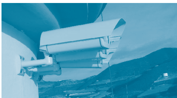
Figura 5: Cámaras de la estación de monitorización costera instalada en el Faro de Sacratif.
