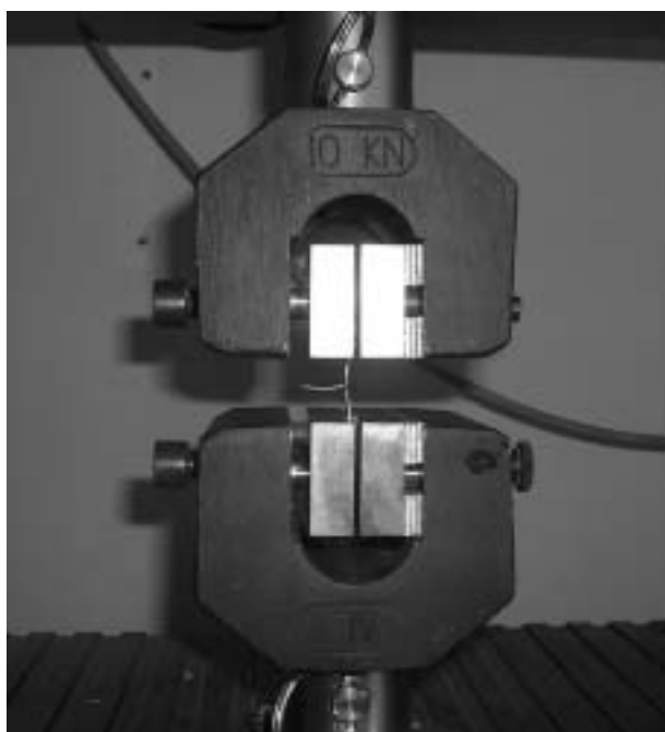
Figura 3. Colocación de los extremos del alambre en las mordazas de la máquina de ensayos durante el proceso de la prueba a tracción del mismo.
