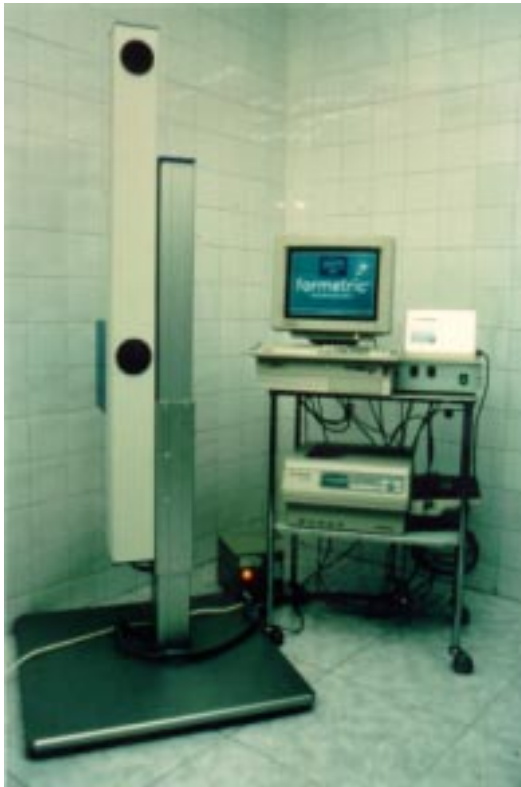
Figura 1.- Equipo de formetría consistente en columna con emisor de luz (parte superior) y cámara de vídeo. Esta columna se regula en altura en función de la del paciente. El registro gráfico se analiza mediante ordenador y se imprime utilizando el programa formetric.
