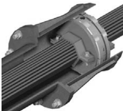
Fig. 2.30 Internal Hydraulic Damper [Lecinq et al , 2003]
