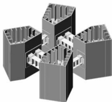
Fig. 5-26 Sección transversal de la torre y disposición del dispositivo (Buckle et al , 2005)
