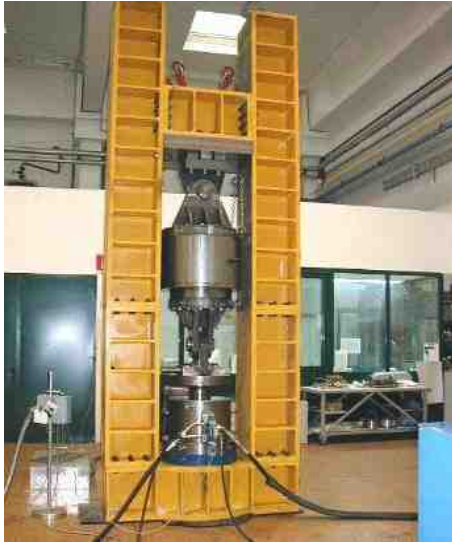
Fig. 6-19 Fusible estructural en una prueba de fatiga (Infanti et al, 2004)
