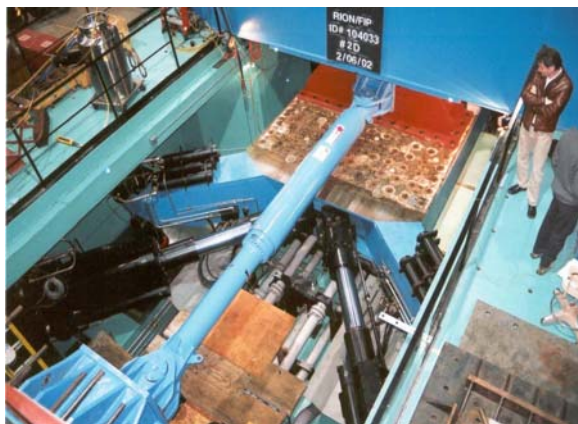
Fig. 6-18 Prototipo del amortiguador viscoso montado en marco de pruebas (Infanti et al, 2004)
