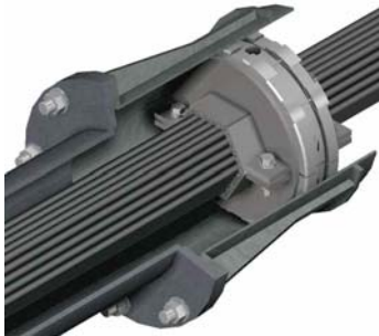
Fig. 6-20 Amortiguador hidráulico interno (Lecinq et al, 2003)
