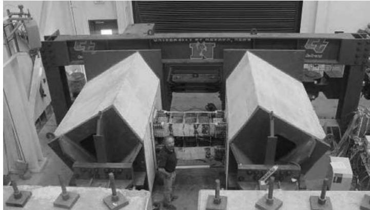
Fig. 5-28 Ensayo de los dispositivos Shear Link en el Laboratorio de Estructuras a Gran Escala, Universidad de Nevada Reno, USA (Buckle et al, 2005)
