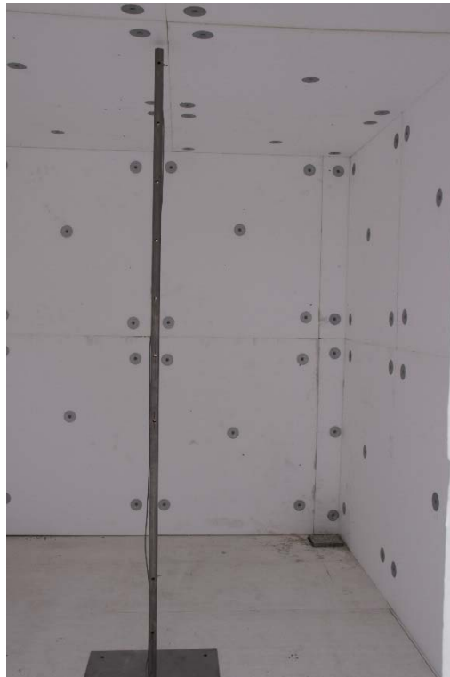
Il·lustració 2.2. Vista interior del compartiment RCT-PIR. Detall de l'arbre de termoparells
