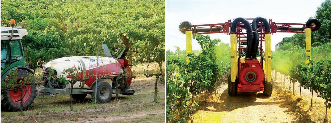
Figura 4. Equipos empleados en los ensayos de deriva en la finca El Castell del Remei. Atomizador convencional (izquierda) y modelo Iris-2 de Illemo Hardi (derecha).
