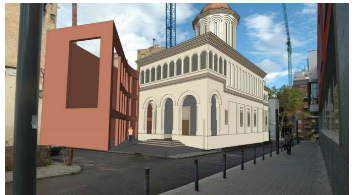
Figura 6. Captura de pantalla de la visualización en RA del edificio superpuesto en su emplazamiento final.
